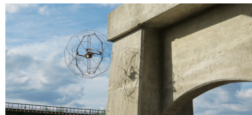
橋梁を点検する球殻ドローン
