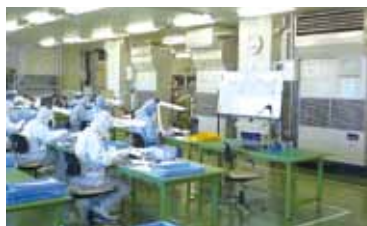
クリーンルーム 改善後は、空調を始業前に20分間運転し、クリーン度レベルを維持している
