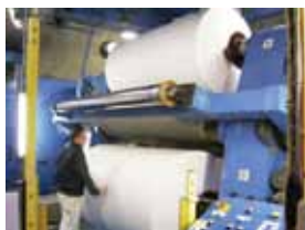
幅200cmのロール紙を自動で次のロールに継ぐ工程。動作タイミングを最適化して、紙継ぎの失敗による紙切れを防ぐ。
