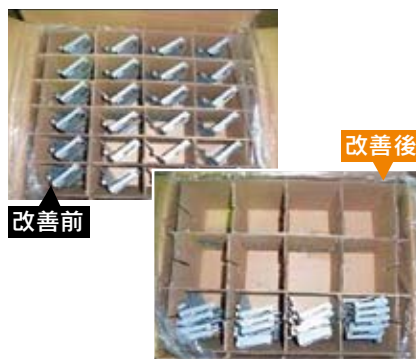
部品を4つまとめて1マスに入れて入り数を増やし、箱のサイズも縮小。改善後、ダンボールの量は1/2に削減。
