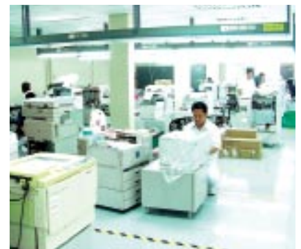
リコータイランドの複写機再生工程
