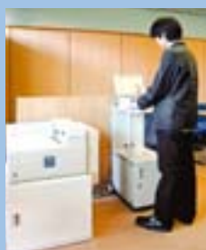
オンデマンド印刷システム。 プリンター横の端末で、自分の印刷ジョブを選択し印刷を行う。
