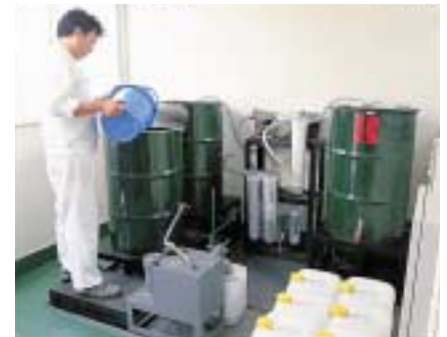
レンズ切削液の再使用システム
