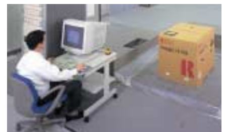
包装の適正強度テスト(振動)
