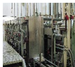
自社開発の水洗浄機
