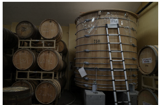
ブレンドしたウイスキーを入れるタンク 【4月20日、福島県郡山市】
