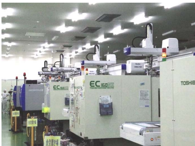
プラスチックレンズ成形工程 (提供) RINS花巻事業所
