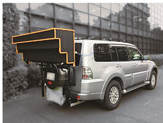
ステレオカメラ5台を搭載した一般車両 （出所）リコーICT研究所
