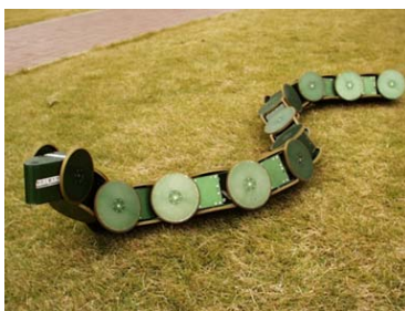
左は初代ヘビ型ロボット「ACM-R3」（長さ175.5cm、幅・高さ11cm、重さ12.1kg）
