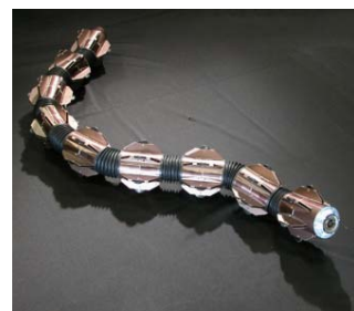
左は初代ヘビ型ロボット「ACM-R3」（長さ175.5cm、幅・高さ11cm、重さ12.1kg）
