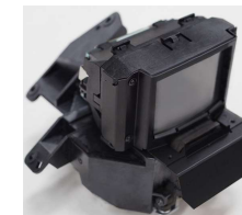
世界初レーザースキャン方式による 車載ヘッドアップディスプレイ
